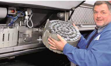
Probennahmesystem für die Ermittlung der Milchgüteproben eines jeden Lieferanten
