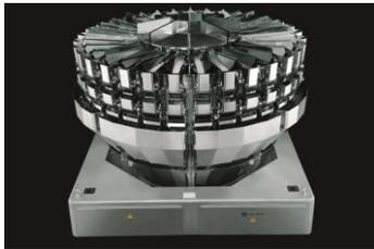
Die neue Mehrkopfwaage CCW-RV-232 von Ishida eignet sich mit 32 seinen Köpfen für anspruchsvolle Mixanwendungen von bis zu acht Komponenten. Bei der Verarbeitung von Monoprodukten lässt sich mit Mehrfachauswürfen Hochleistung (440 Wiegungen/Min) erreichen. Daneben zeigt Ishida die Cut Gate Waage für Granulate und Pulver in runder Konstruktion. Ab sofort erhältlich sind zwei Modelle mit 8 oder
