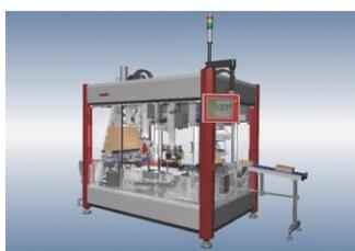
Somic zeigt eine kompakte Version seiner Endverpackungsmaschine, die gegenüber der 424-Typenreihe einen Leistungssprung von über 50% bietet. Basis dafür ist eine gemeinsame Systemplattform für alle individuellen Maschinenvarianten.
