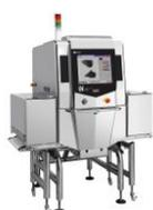
Das ebenfalls neue Röntgenprüfsystem IX-G2 arbeitet mit der Dual Energy Technik und ist daher besonders leistungsstark. Das Verfahren nutzt gleichzeitig zwei energetisch leicht unterschiedliche Strahlungsquellen, für jeden Messpunkt im Röntgenbild existieren also zwei Werte, die miteinander verglichen werden. Das IX-G2 eignet sich
