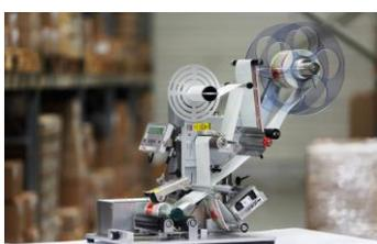
Mit der halbautomatischen **Rundum-Etikettieranlage Geset 141** von Blum Systeme mit integriertem Tintenstrahldrucker lassen sich Laschen etc. etikettieren. Diese Lösung wurde speziell für Unternehmen entwickelt, die kleine Chargen flexibel mit Daten wie dem Verfallsdatum etikettieren müssen. Klassische Einsatzgebiete
