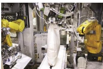
Die vielseitigen Offensack-Absackanlagen der PTR-1030 SERIE von Premier Tech Chronos (PTC) sind zur Abfüllung von frei fließendem Schüttgut in einer Vielzahl verschiedener Sackarten und Sackmaterialien ausgelegt und erreichen eine Leistung von bis zu 1.100 Säcken pro Stunde. Für die Verarbeitung von Luftdurchlässige
