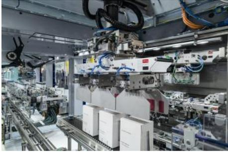
Die TLM-Verpackungsanlage für das Kartonieren der Aerosoldosen wird nach der interpack an einen Kunden ausgeliefert. Die Anlage besteht aus nur vier Teilmaschinen. Sie verarbeitet aktuell Aerosoldosen in vier verschiedenen Größen und stellt Shelf-Ready-Kartons in vier unterschiedlichen Abmessungen her (Kartontray plus Deckel). Die Leistung liegt bei 320 Produkten pro Minute. Der Werkzeugwechsel erfolgt innerhalb weniger als 5 Minuten vollautomatisch.
