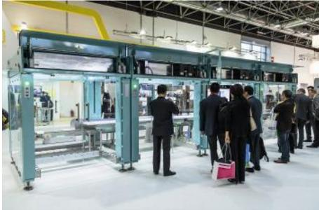
Der Prototyp der weltweit ersten Verpackungsmaschine ohne Schaltschrank. Die Gerhard Schubert GmbH hat diese Innovation auf der interpack 2014 präsentiert. Bei der neuen TLM-Generation gehören die Servoverstärker innerhalb einer dezentralen Steuerungsarchitektur zum TLM-Roboter und benötigen keinen Schaltschrankplatz mehr. Außerdem wurde die Anzahl der elektronischen Teile erheblich reduziert.
