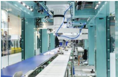
Der Prototyp der schaltschranklosen Verpackungsmaschine verarbeitet alle greifbaren Produkte. Auf der Messemaschine wurden Infusionsbeutel gehandhabt.
