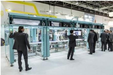
Gerald Schubert, Gesellschafter der Gerhard Schubert GmbH (links) öffnet die Abdeckung im Kopfteil der Maschine. Hier ist normalerweise der Schaltschrank der TLM-Verpackungsmaschine untergebracht. Beim Prototypen der neuen Maschinengeneration ist das Fach nahezu leer.
