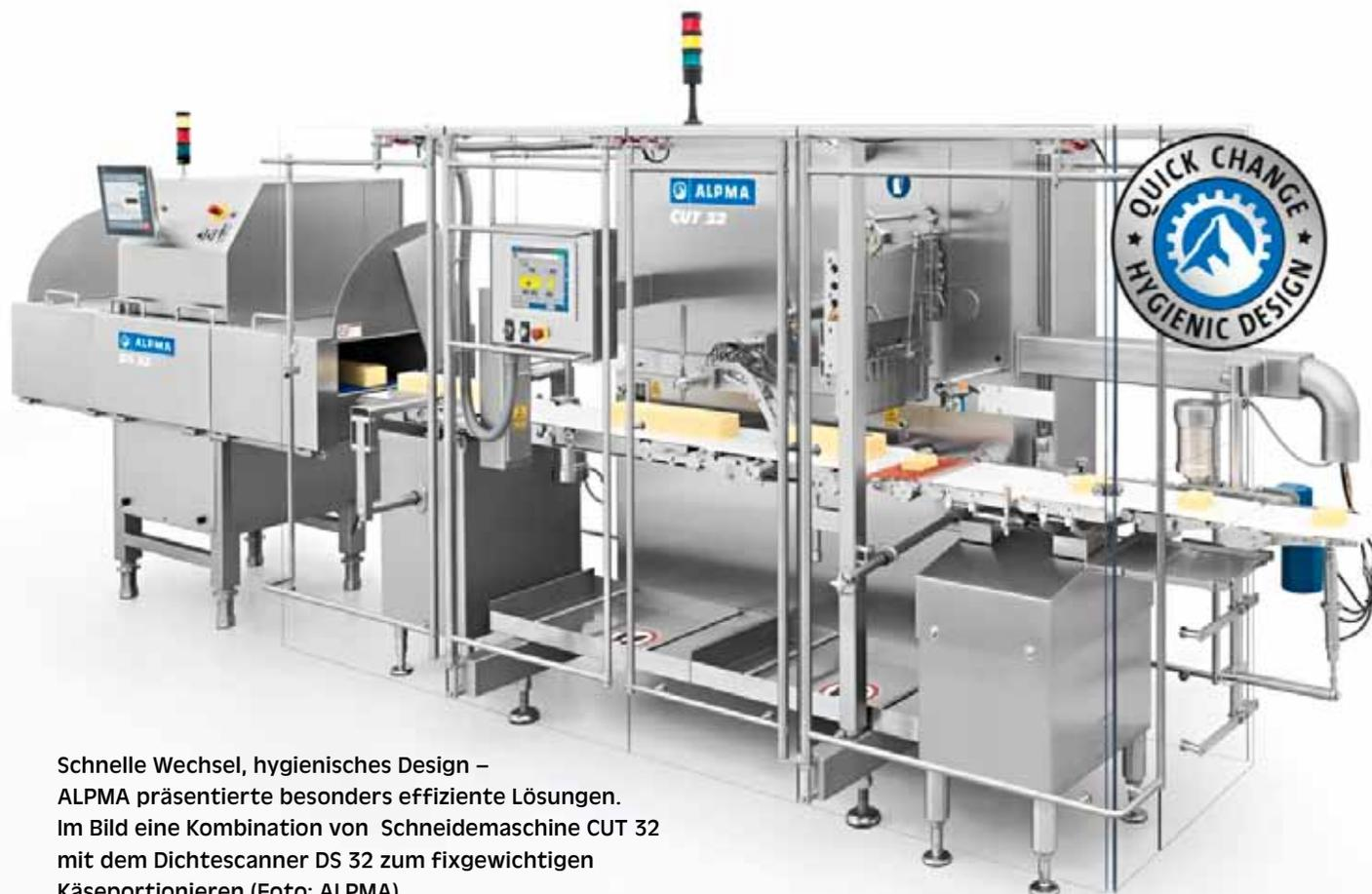
Schnelle Wechsel, hygienisches Design – ALPMA präsentierte besonders effiziente Lösungen. Im Bild eine Kombination von Schneidemaschine CUT 32 mit dem Dichtescanner DS 32 zum fixgewichtigen Käseportionieren (Foto: ALPMA)
