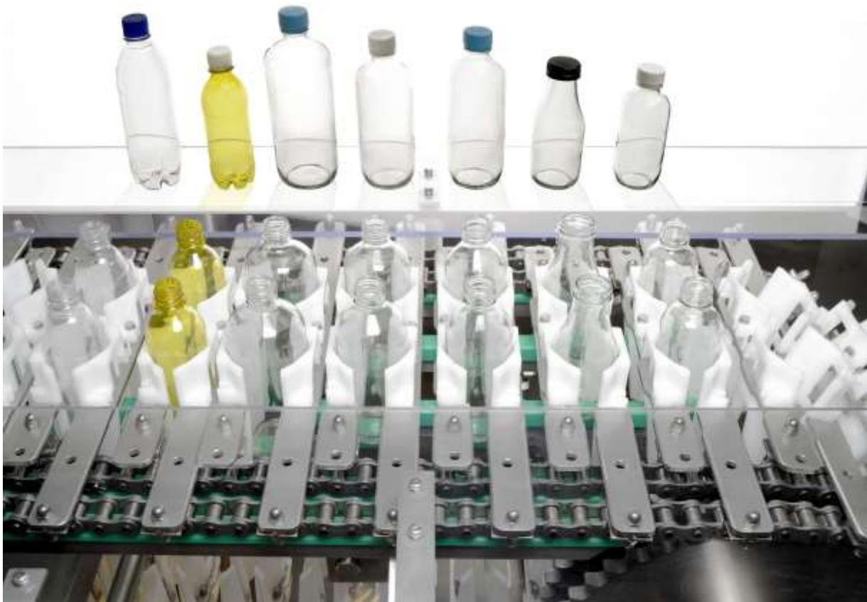
Packtech zeigte ein neues Konzept für einen linearen Flaschenfüller, bei dem die Gebinde nicht am Hals sondern in verstellbaren Taschen geführt werden (Foto: SH+E)
